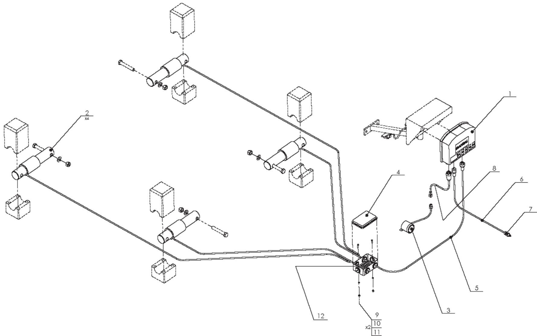
**Система взвешивающего устройства**
