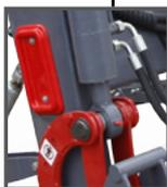
Основная рама (стрелы) изготовлена из листового металла (4 мм и 6 мм). Соответствующий вид мелкозернистой стали и форма профилей стрелы обеспечивает максимальную прочность и низкий вес. Конструкция рамы обеспечивает оптимальную видимость с места водителя трактора.
