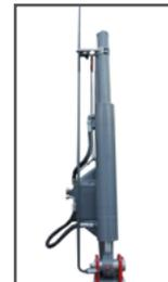
Погрузчик стандартно оснащен индикатором выравнивания оснастки.
