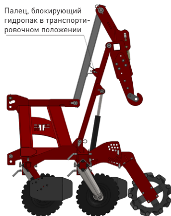
Рис. 11. Способ блокировки культиватора в транспортном положении.
