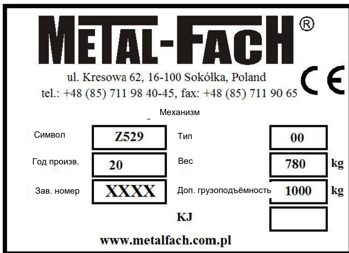
рисунок 1. Данные, указанные на заводском щитке.
