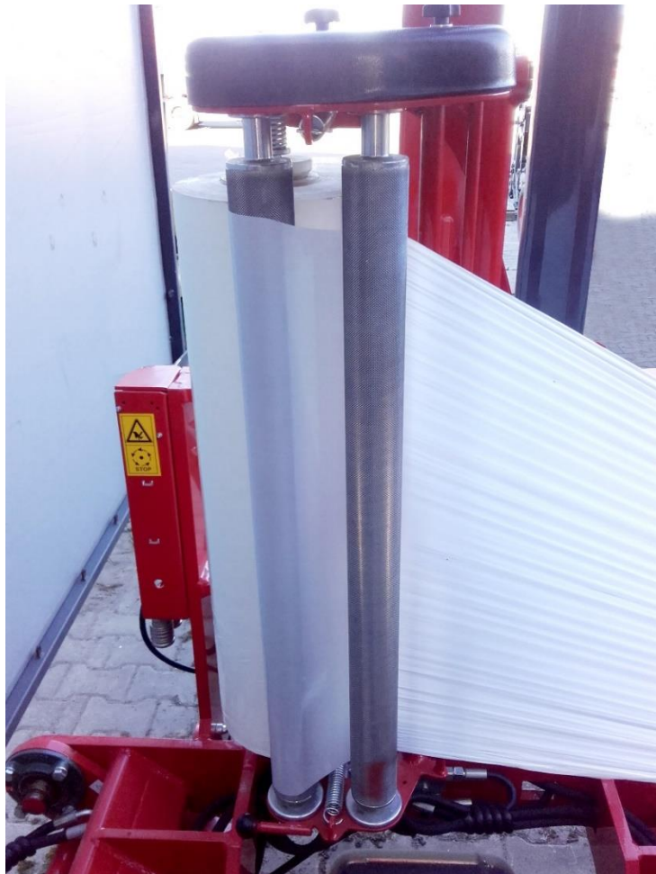
рисунок 33. Правильная установка пленки в подавателе
