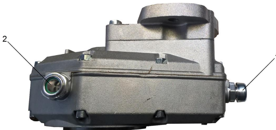
рисунок 42. Вид угловой передачи
