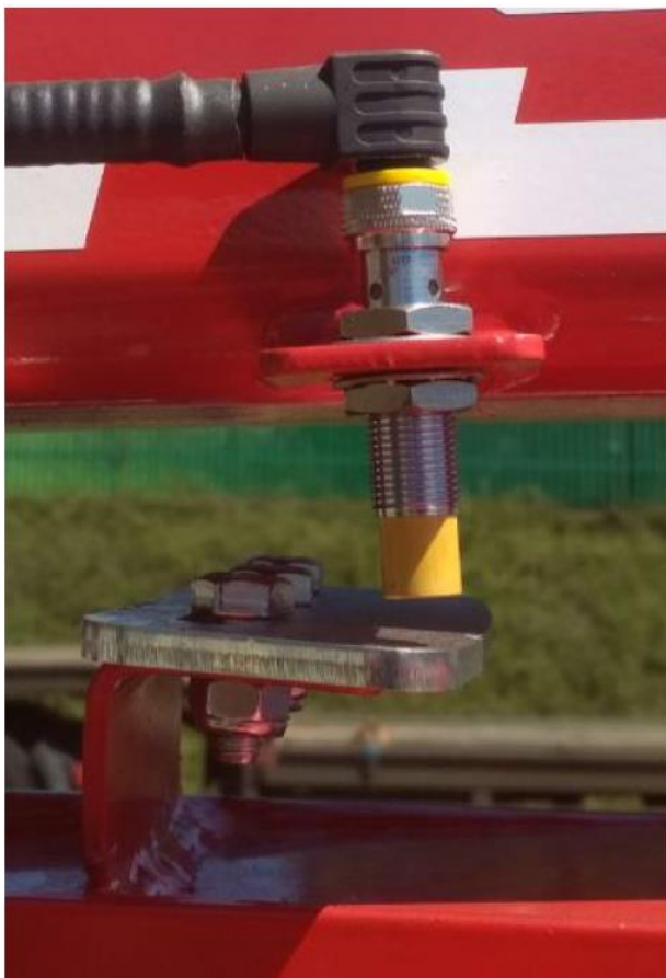
рисунок 22. Установка индукционного датчика оборотов
