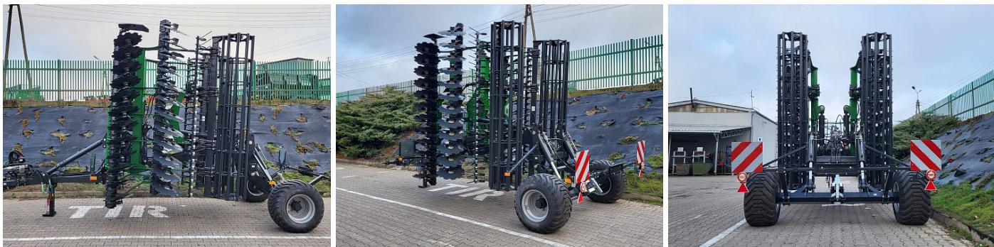
**Дискатор Metal-Fach U710 6м** предназначен для эффективного лущения стерни после уборки зерновых, кукурузы и подсолнечника, предпосевной подготовки почвы, измельчения пожнивных остатков с их равномерной заделкой и борьбы с сорняками.
