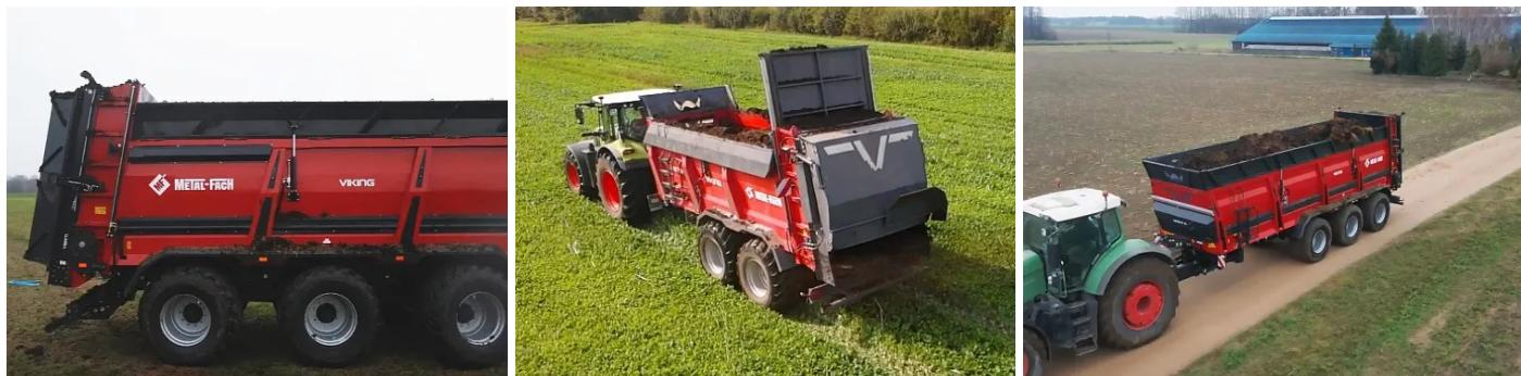
**Навозоразбрасыватель Metal-Fach Viking 272/7 36т** — это высокопроизводительный агрегат, предназначенный для транспортировки и равномерного внесения на поля органических удобрений: навоза, компоста, торфа и сепарированной твердой фракции.
