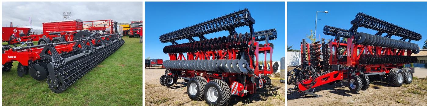
**Дискатор Metal-Fach U710 12,5 метров** - это тяжелая двухрядная дисковая борона, предназначенная для основной и предпосевной обработки почвы на глубину до 15 см, эффективного рыхления, уничтожения сорняков, измельчения пожнивных остатков и подготовки земли к посеву.
