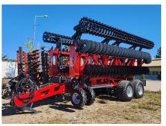
**Дискатор Metal-Fach U710 12,5 метров** - это тяжелая двухрядная дисковая борона, предназначенная для основной и предпосевной обработки почвы на глубину до 15 см, эффективного рыхления, уничтожения сорняков, измельчения пожнивных остатков и подготовки земли к посеву.
