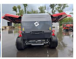
**Пресс-подборщик с фиксированной камерой прессования Z603** — это современная сельскохозяйственная машина, разработанная с учетом потребностей самых требовательных пользователей. Камера пресс-подборщика состоит из 18 вальцов. Он разработан для обеспечения максимальной эффективности при уборке как сухих, так и влажных материалов.
