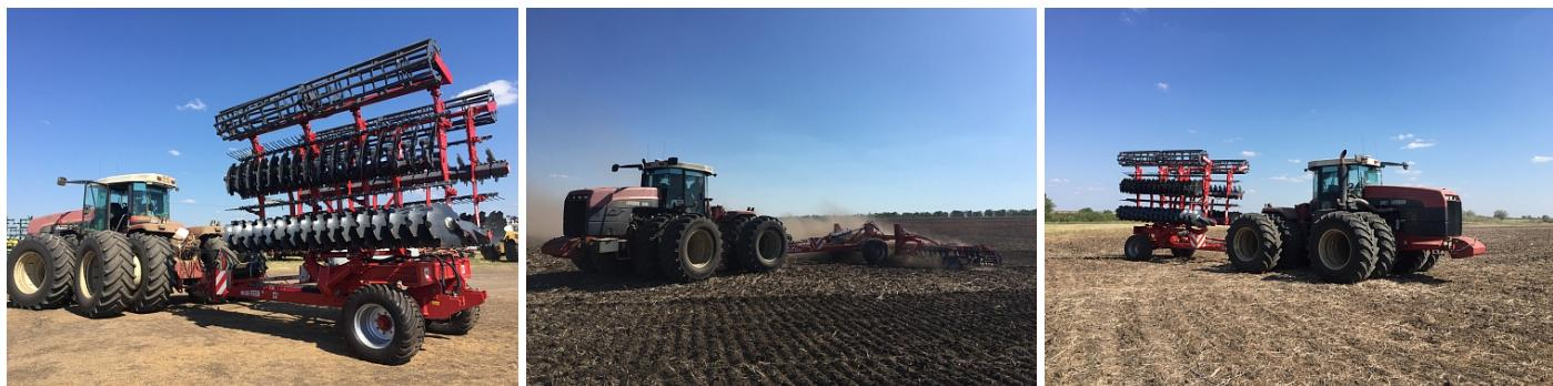
Тяжелый дискатор Metal-Fach U786 8м предназначен для выполнения полного комплекса почвообрабатывающих операций: интенсивного лущения стерни после уборки зерновых, кукурузы и подсолнечника, предпосевной подготовки почвы, измельчения и равномерной заделки пожнивных остатков, борьбы с сорняками. Благодаря массе 10 800 кг и дискам диаметром 620 мм агрегат обеспечивает заглубление до 18 см даже на самых тяжелых почвах.
